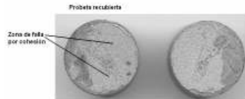
Figura 5. Macrografía de las probetas donde se indica la falla cohesiva en recubrimiento A.
