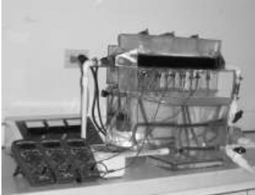
**Figura 2.** Montaje de celdas electrolíticas
