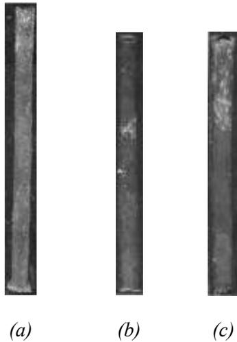
**Figura 3.** Análisis de Conformación. a).  $0.4 \text{ mm}$ ,  $10 \text{ Adm}^{-2}$ ,  $10 \text{ mm s}^{-1}$ . b)  $0.4 \text{ mm}$ ,  $4 \text{ A dm}^{-2}$ ,  $10 \text{ mm s}^{-1}$ . c)  $0.4 \text{ mm}$ ,  $10 \text{ A dm}^{-2}$ ,  $60 \text{ mm s}^{-1}$
