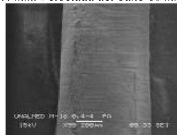
*Densidad de corriente 4 A/dm<sup>2</sup>. Diámetro 0.4 mm. Velocidad del baño 60 mm/s*
