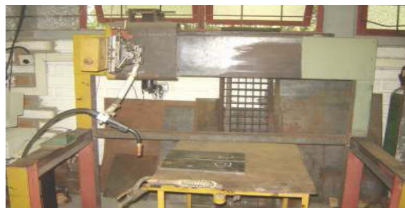
Figura 4. Montaje para realizar los cordones de soldadura BOP
