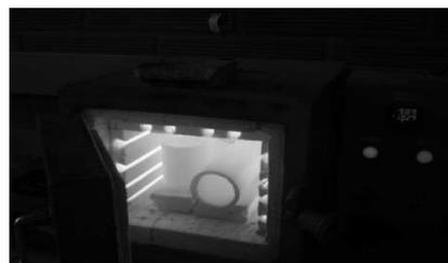
**Figura 3.** Incandescencia del tubo de SiC durante su tratamiento térmico
