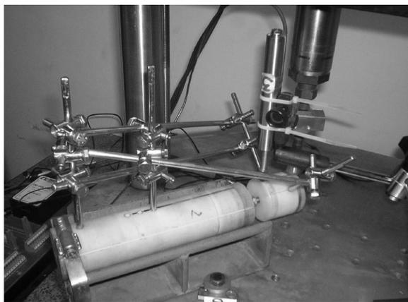
**Figura 3.** Montaje experimental para la prueba de flexión antero posterior (AP). Configuración en V
