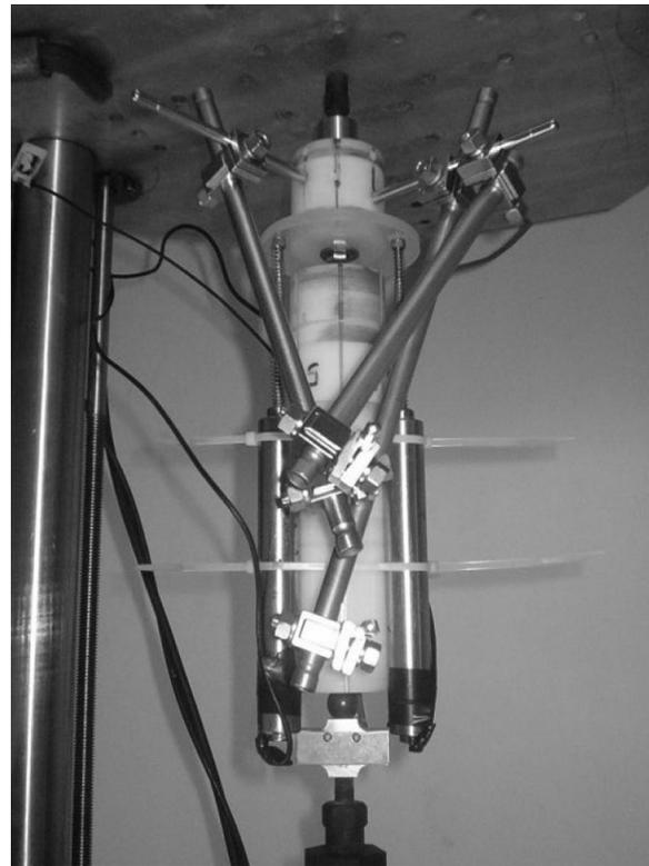
**Figura 4.** Montaje experimental para la prueba de carga axial con conectores y barras AO. Configuración V
