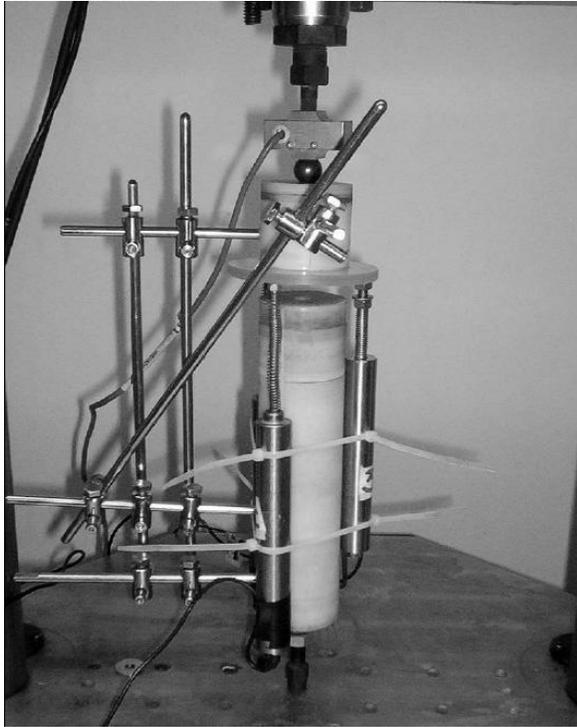
**Figura 2.** Montaje experimental para la prueba de carga axial. Configuración Semi V
