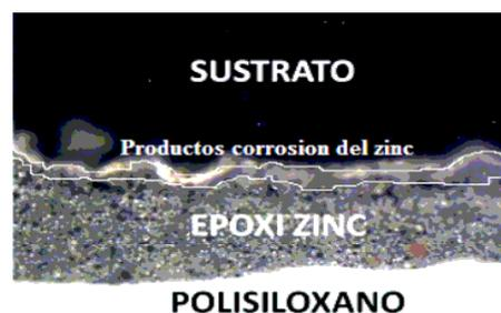
**Figura 1.** Micrografías transversales para Epoxi-zinc/ Polisiloxano
