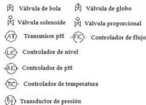
Figura 2. Nomenclatura del módulo de control.
