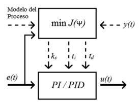
**Figura 1.** Diagrama de bloques para el método de autosintonización propuesto
