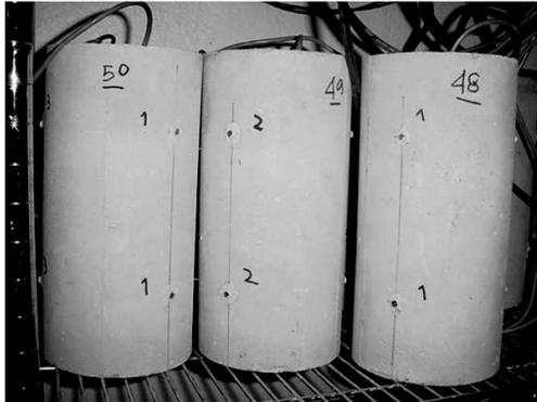
**Figura. 3** Probetas con puntos de medida de deformaciones adheridos en la superficie y comparador de longitudes DEMEC N°8865. (De la Cruz, 2006)
