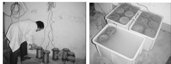
**Figura. 2** Procedimiento, Ensayo de Retracción y Fluencia en probetas de HAC-RMCA(De la Cruz, 2006)
