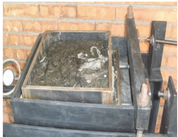
Figura 5. Compactación de la muestra antes de la etapa de corte Fuente: Los autores
