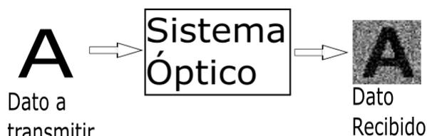
Figura 1. Distorsión de la información debido a la transmisión óptica.
