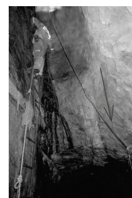
Figura 12. Vía de preparación por el buzamiento de la veta tipo “tambor”. Los macizos de veta, piso y techo son de buena calidad, los contactos son cerrados lo cual se manifiesta en estabilidad aún en inclinaciones de veta casi verticales. Se marcan las estructuras que eventualmente pudieran definir la inestabilidad en un proceso de deterioro futuro, especialmente por efecto del agua y desconfinamiento de base; un método de explotación de corte y relleno ascendente puede manejar esta situación de forma satisfactoria. El Bagre, Antioquia.
