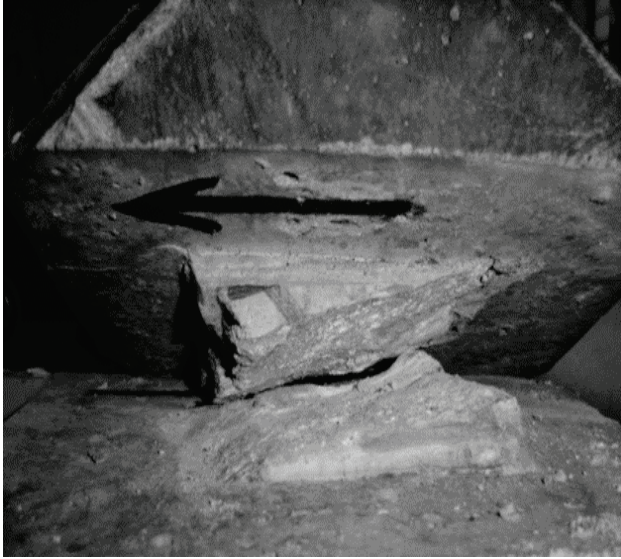
Figura 17. Aspecto de plano de falla en el ensayo de corte directo sobre discontinuidades en veta. Fuente: Fotografía tomada por Álvaro Castro.
