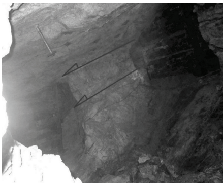
Figura 10. Veta inclinada, pilar que se encuentra bajo esfuerzos de compresión y de corte. Se marcan las estructuras débiles naturales preexistentes que pueden inducir deslizamiento debido al desconfinamiento y a superación de la resistencia al cortante de las discontinuidades. En la estructura del pilar no se evidencian fracturas verticales o diagonales que pudieran indicar falla por compresión o por cortante a través del cuerpo de roca. El grado de oxidación de los minerales es incipiente. La posibilidad de reemplazo de pilares con otros materiales es una opción por evaluar. El Bagre, Antioquia.
