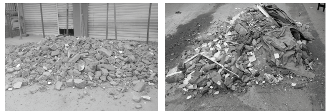
Figura 2. Residuo de mampostería obtenido de RCD de casas remodeladas. Fuente: Los Autores.
