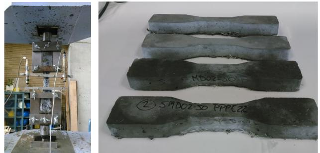
Figura 6. Cuerpo de prueba *dogbone* y configuración del ensayo de tracción directa conforme a JSCE-08 [56]
