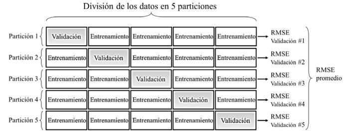
Figura 4. Esquema de la validación cruzada tipo  $k$ -fold. Fuente: Autores.
