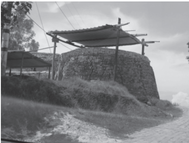
Figura 2. Hornos de fuego dormido para la cocción de ladrillos, zona de los Alpes de Sogamoso
