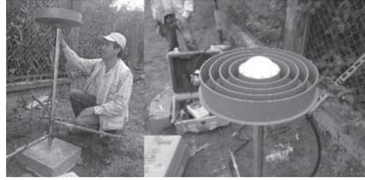
Fig. 8. Establecimiento de receptor GNSS en UQ-01
