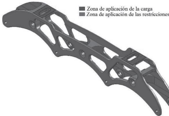
Fig. 4. Zonas de aplicación de las condiciones de borde.
