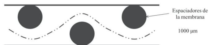
Fig 3. Corriente de alimentación a través de una membrana con espaciadores.
