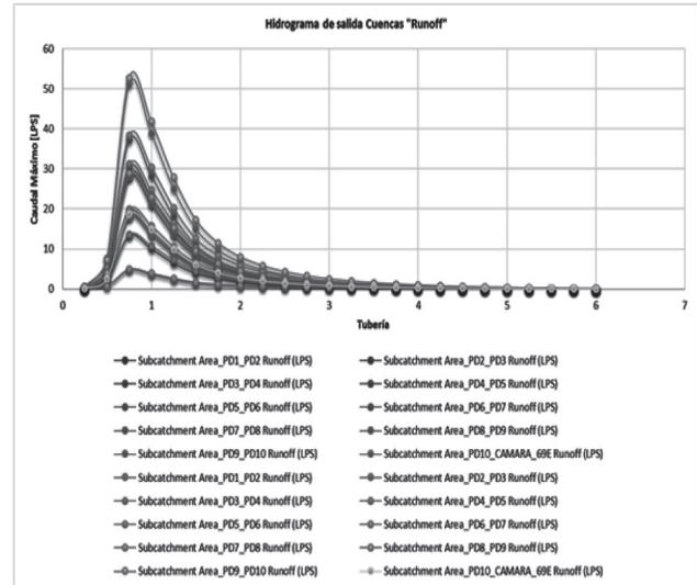
Fig. 14. Hidrogramas de salida de cada uno de los nodos (pozos) – Reducción de los caudales picos – Escenario 2 - Parte 2.
