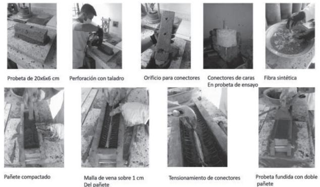
Fig. 16. Proceso de refuerzo con pañete de la probeta de la viga de tapia.
