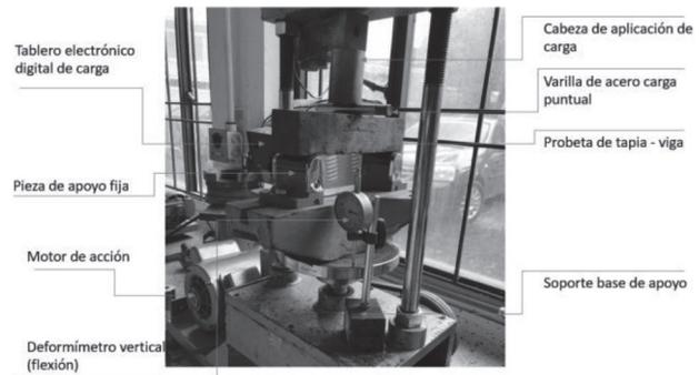
Fig.8. Equipo de ensayo para la probeta de la viga de tapia.
