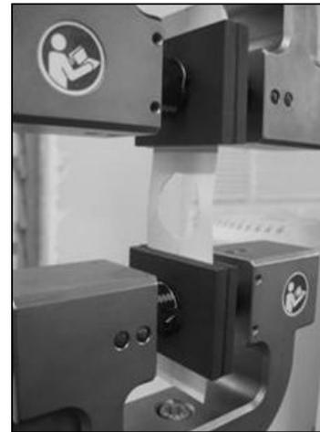
**Figura 3.** Sujeción de las fibras de carbono, aramida y de vidrio para las pruebas de resistencia a la tracción
