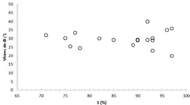
**Figura 4.** Variación del esfuerzo cortante vs. el grado de saturación
