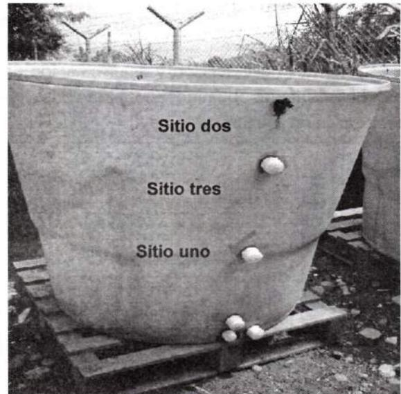
Foto 1. Celda experimental abierta con orificios para muestreo
