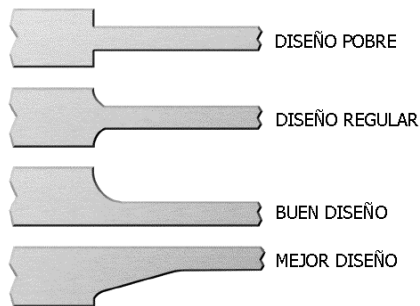
Figura 10. Formas recomendadas de cambio de sección. Fuente: Hitchiner Manufacturing Co. Inc., Designing for investment casting , Technical Updated 2D1.
