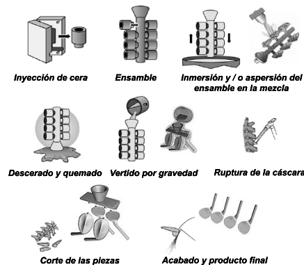
Figura 1. Proceso de microfundición. Fuente: http://www.hitc-hiner.com/home.html , http://www.kp.dlr.de/
