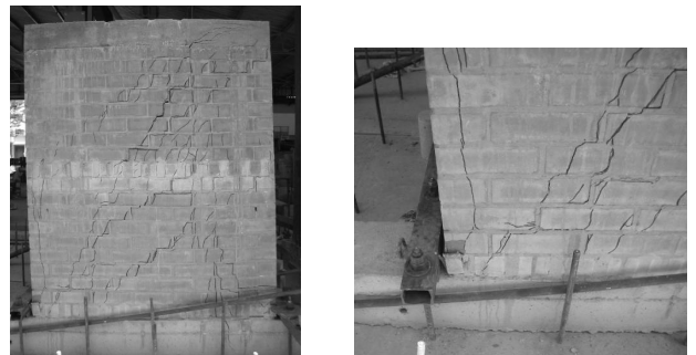
Fotografía 2. Ensayo monotónico - Detalles de fisuración muros Tipo I y Tipo II
