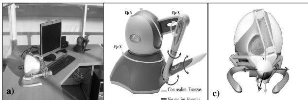
Figura 2. Interfaces hapticas usadas. a) Estación de trabajo. b) Interfaz Phantom Omni®. c) Interfaz Novint Falcon™
