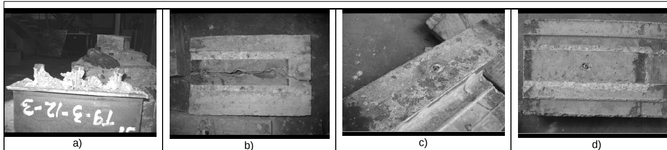
Figura 4. a) Estado final de los conectores en la falla del concreto. b) Estado final de la placa de concreto. c) Estado final del perfil metálico en la falla de la soldadura. d) Tornillo embebido en la placa de concreto ante la falla de la soldadura. (Tomado de Hurtado, 2005).
