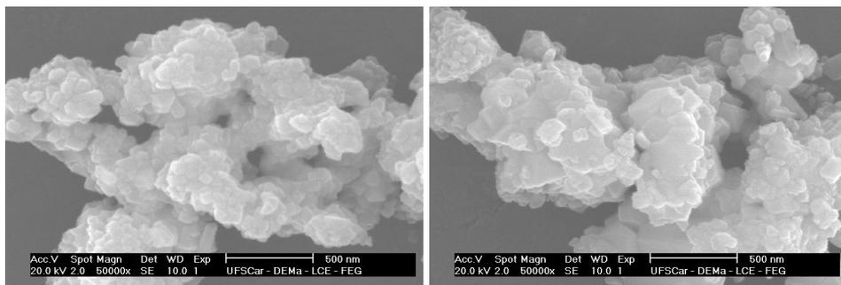
**Figure 2:** Micrografías de polvos cerámicos con composición 0,90PZN-0,10PT obtenidos por el método de reacción por combustión cuando fue usado como combustible mezcla de (a) urea/glicina y (b) TFTA.
