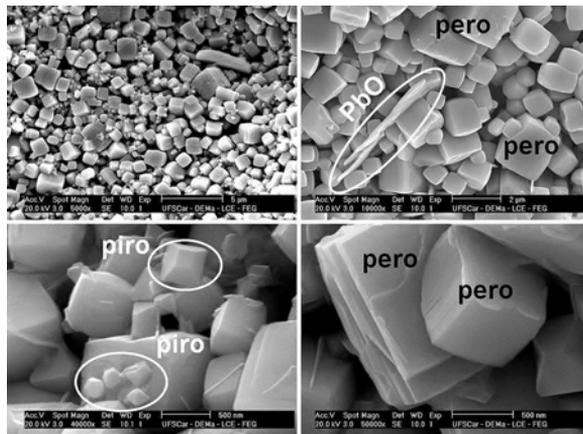
**Figure 5:** Microscopia electrónica de barrido de la superficie de fractura del interior de la muestra del sistema 0,90PZN-0,10PT, sometida a análisis de dilatometría hasta una temperatura de  $1000^{\circ}\text{C}$ , para diferentes aumentos: (a) 5000X, (b) 10000X, (c) 40000X y (d) 50000X. Con análisis de EDS, fueron identificadas las fases: pirocloro (piro), perovskita (pero) y  $\text{PbO}$  ( $\text{PbO}$ )
