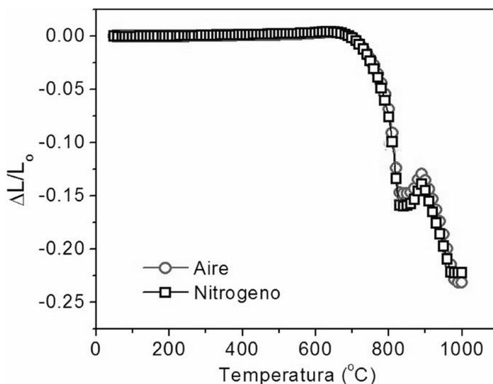
**Figure 3:** Curvas de dilatométrica, en aire y nitrógeno, para el sistema 0,90PZN-0,10PT, obtenido por el método de combustión usando como combustible la mezcla glicina/urea ( $\sim 70\%$  de fase perovskita). Tasa de calentamiento  $5^{\circ}\text{C}/\text{min}$ .
