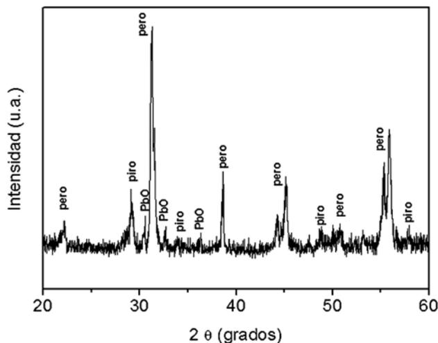
**Figure 4:** Patrón de difracción de rayos-X de la superficie de fractura del interior de la muestra, obtenida a partir de polvos sintetizados por combustión, y sometidos a análisis de dilatometría hasta una temperatura de  $1000^{\circ}\text{C}$ , en atmósfera de nitrógeno.
