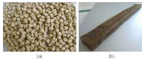
Figura 2. Muestra de pellets conformados en la mezcladora en seco y (b) Probeta de WPC obtenida por extrusión.
