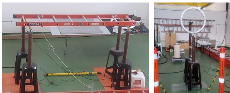
Figura 6. Ensayo a escalera dieléctrica y a detector de tensión
