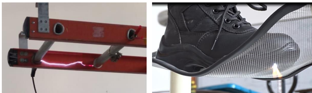
Figura 11. Ensayo a escalera y calzado dieléctrico
