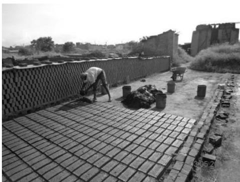
Figura 3. Proceso de moldeo
