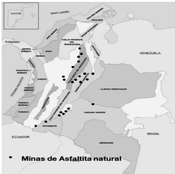
**Figura 2.** Distribución de las cuencas sedimentarias de Colombia y minas con asphaltitas (círculos negros corresponden a las minas autorizadas de asphaltita natural). Fuente: adaptado de Villamil (14) y Barrero(15)
