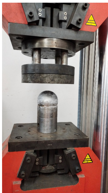
Figura 3. Dispositivo para el ensayo de determinación de las CLF, con sus elementos de acople a la maquina universal IBERTEST, modelo IBMT2-600. Fuente: Elaboración propia
