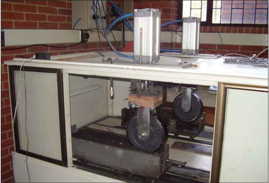
Figura 9. Equipo de deformación permanente en mezclas asfálticas
