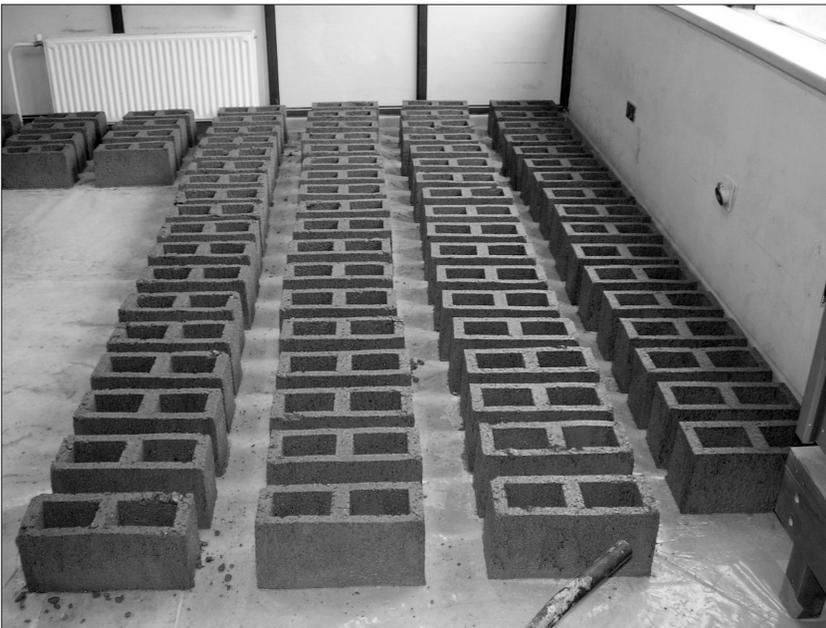
**Figura 3.** Fabricación de bloques de hormigón
