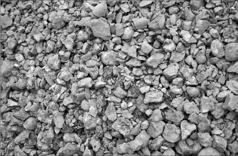
**Figura 2.** Árido reciclado después de la trituración
