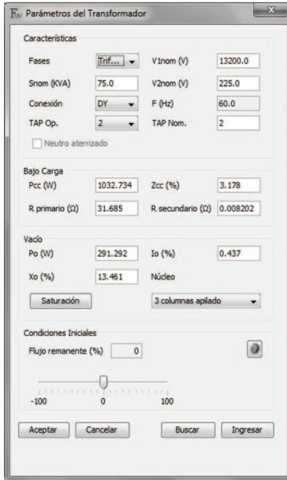
FIGURA 8. VENTANA DE PARÁMETROS DEL TRANSFORMADOR EN FERROUV
