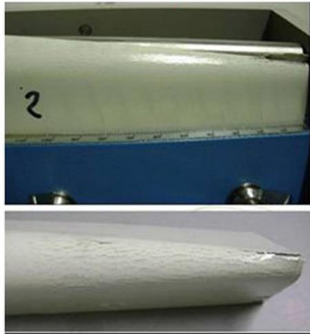
**Figura 5.** Ensayo de doblez a probetas con el sistema de pinturas aplicado
