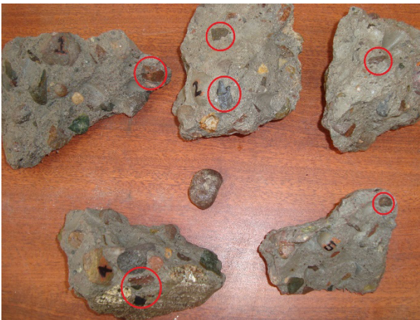
Figura 2. Piezas de HO ensayadas con la ASTM C642.
