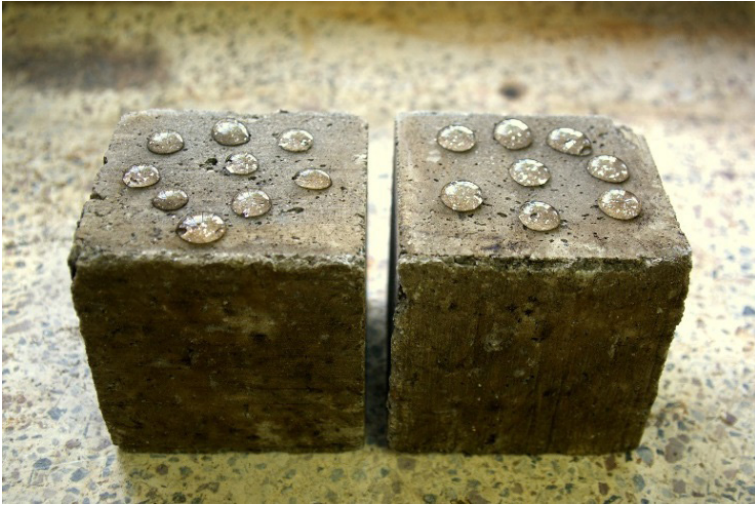
Figura 1. Bloque de concreto con emulsión asfáltica.
