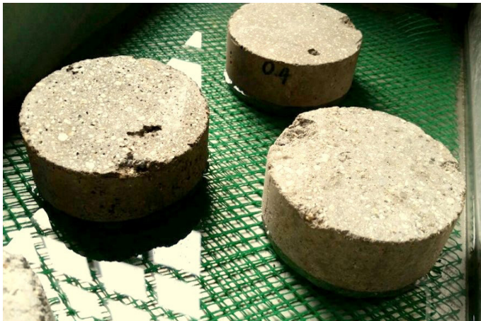
Figura 4. Muestras cilíndricas de 100 mm. de diámetro y 50 mm. de altura.
