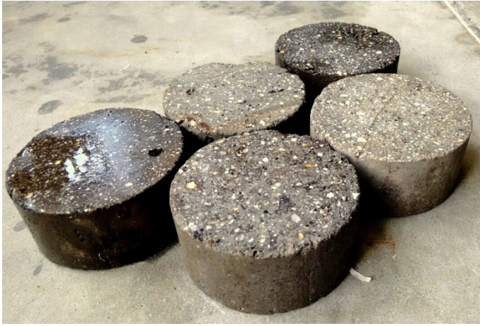
Figura 3. Muestras cilíndricas cortadas con sierra diamantada.
