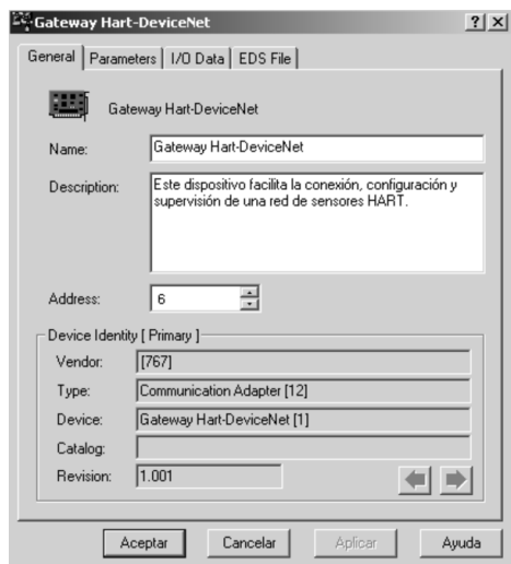
Figura 6. Ventana de propiedades del dispositivo Gateway Hart-DeviceNet.
