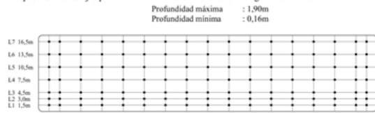
Disposición de los ejes para el levantamiento batimétrico de la laguna facultativa
