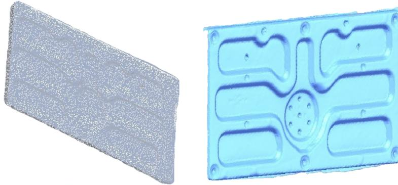
**Figura 7.** Nube de puntos y modelo capturado.
