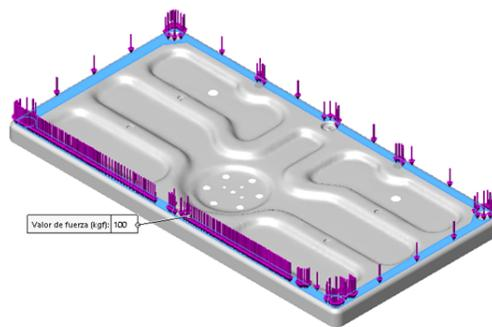
**Figura 12.** Configuración de la carga aplicada.
