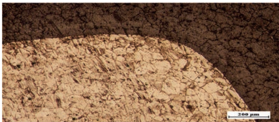
Fig. 7. EN ESTA REGIÓN DE LA MUESTRA SE OBSERVA UN BUEN CONTRASTE ENTRE LA ZONA OSCURA MÁS AFECTADA Y LA ZONA MÁS CLARA. SE APRECIA NUMEROSAS GRIETAS, PRINCIPALMENTE EN LA ZONA OSCURA Y EN EL MATERIAL SE OBSERVAN MACLAS, LAS CUALES, EN ESTE CASO, PUEDEN DEBERSE AL CRECIMIENTO DE GRANO POR AFECTACIÓN TÉRMICA DEL MATERIAL, ES DECIR, POR HABER ESTADO SOMETIDO A DETERMINADAS TEMPERATURAS DURANTE UN DETERMINADO PERIODO DE TIEMPO. (AUMENTOS: 500X)
