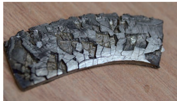
Fig. 2. MUESTRA LAMINADA QUE EXHIBE FRAGILIZACIÓN DEL MATERIAL
