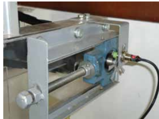
Fig. 10. DETALLE DEL ENSAMBLE DEL SENSOR DE PROXIMIDAD
