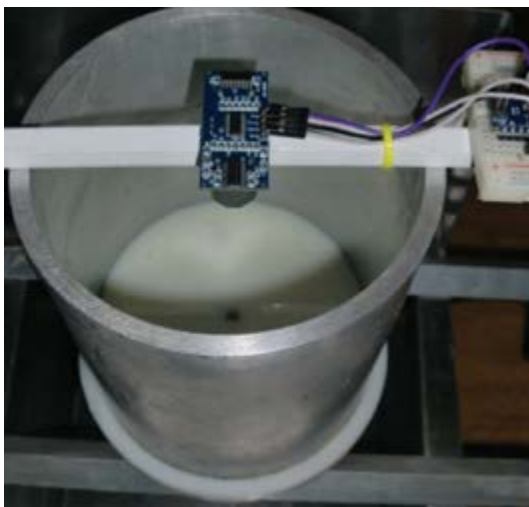
Fig. 1. MONTAJE FÍSICO DEL CONTENEDOR DE AGUA INSTRUMENTADO CON UN SENSOR DE DISTANCIA ULTRASÓNICO
