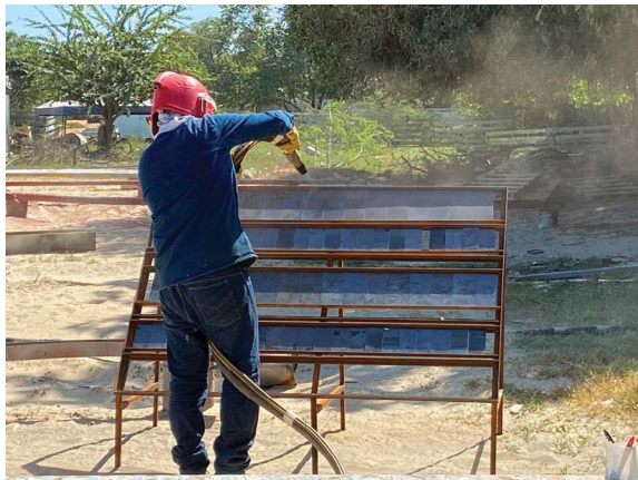
(a) Preparación con chorro abrasivo
