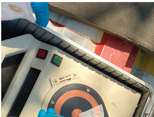
(a) Equipo de medición de sales contaminantes.
