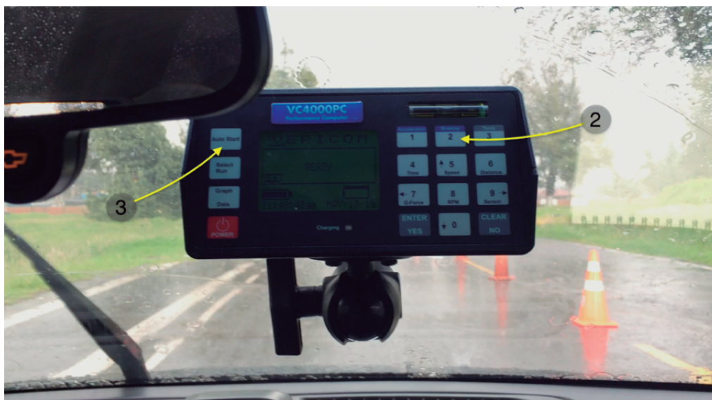
Figura 3. Vericom VC4000PC instalado en el interior del vehículo.
