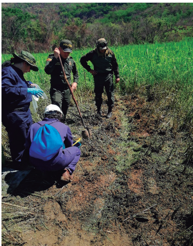
Figura 4. Suelo después de la detonación de la carga de pentolita de 250 g.
