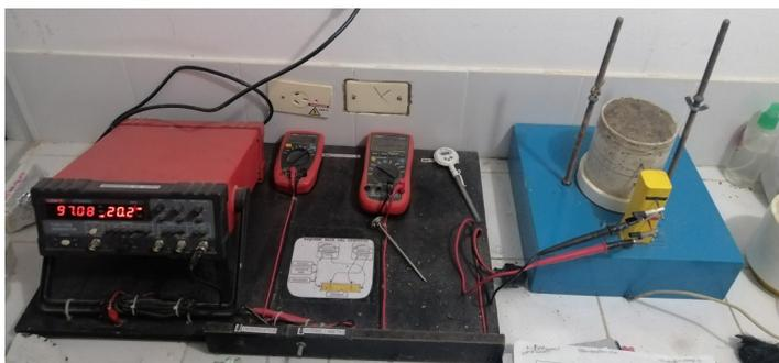
Nota. Se muestra el Equipo de los cuatro electrodos de Wenner, ensamblado por Álvarez Vega (2018) y adaptado a la muestra de suelo compactada.
