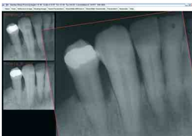
FIGURA 5. Aplicación para el registro manual. En esta aplicación el experto puede cargar las radiografías a registrar y aplicar manualmente traslación, rotación y escalamiento a la imagen flotante.
